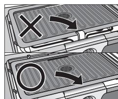
温度調節ダイヤル側のフック状の金属部分が見えないよう、正しくセットしてください。
