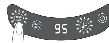
保温ボタンを押すと、温度設定ボタンが点滅したまま、保温ボタンが点滅します。設定温度に加熱した後、その温度で保温します。
