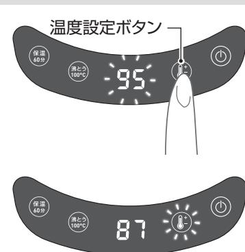
加熱中は、温度設定ボタンが点滅します。
