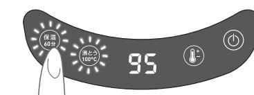
保温ボタンを押すと、沸とうボタンが点滅したまま、保温ボタンが点滅します。沸とう後は、95°Cで保温します。
