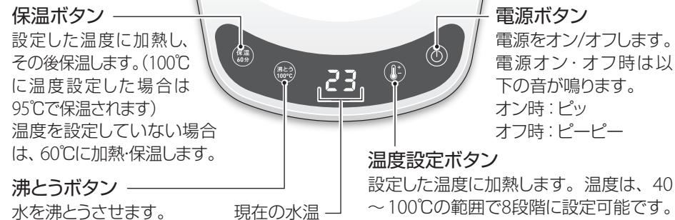
※ 操作パネルは何も押さない状態で約30分経つと、スタンバイモードになります。電源ボタン以外の表示がオフになります。（電源ボタンのみ点滅）スタンバイモード中に再度電源ボタンを押すと、すべてのボタンの表示がオンになります。
