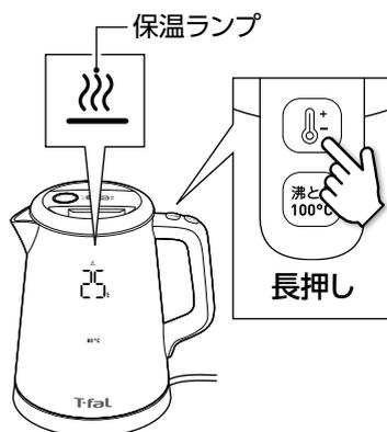
加熱中は、温度設定表示が点灯します。
