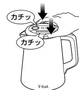
**注意** ふたを片側ずつ、カチッと音がするまで上から確実に押しこみます。ふたが完全に取り付けられていることを必ず確認してください。
