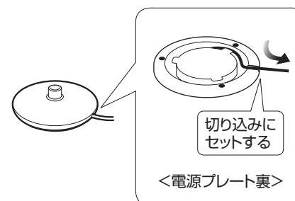
コードを電源プレート裏側に巻きつけて、長さを調節します。
