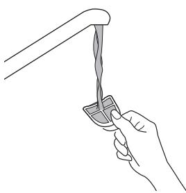
フィルターのタブを持ってケトル本体からフィルターを引き抜き、水洗いしてください。
