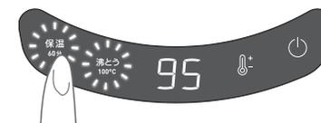
保温ボタンを押すと、沸とうボタンが点滅したまま、保温ボタンが点滅します。沸とう後は、95℃で保温します。
