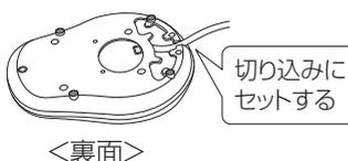
電源プレート裏の切り込みに電源コードを確実にセットしてください。
