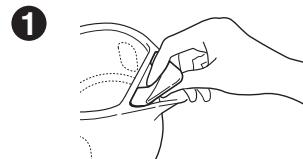
本体が冷めるのを待ってから、ふたを開け、図のようにフィルター上部を持って、ケトル本体からフィルターを引き抜きます。
