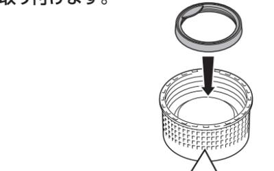
パッキンの溝をふたの突起に合わせさせて取り付けます。
