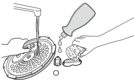
金属ふたからバルブカバー、ボールカバー、減圧ボールを取りはずし、各部品を中性洗剤で洗います。(取りはずし方は16ページ「圧力調理前の点検事項」を参照してください) パッキングは金属ふたから取りはずしできませんが、汚れが残らないようによく洗ってください。
