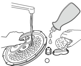
金属ふたからバルブカバー、ボールカバー、減圧ボールを取りはずし、各部品を中性洗剤で洗います。(取りはずし方は16ページ「圧力調理前の点検事項」を参照してください)
