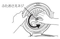
グルブカバーを回転させるようにして金属ふたから取りはずします。
