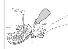
金属ふたからバルブカバー、ボールカバー、減圧ボールを取りはずし、各部品を中性洗剤で洗います。(取りはずし方は18ページ「圧力調理前の点検事項」を参照してください)パッキングは金属ふたから取りはずしできませんが、汚れが残らないようによく洗ってください。
