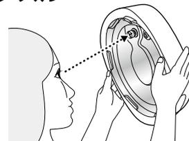
圧力調整おもりを外した後、明るい場所にかざし、ノズルに目詰まりがないか点検します。
