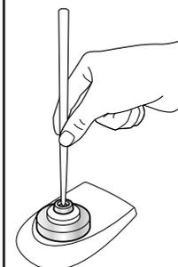
先の丸いはしなどで強めに押し、バネが押し戻すような感触があるか確認します。
