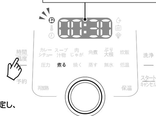
② 操作ノブを回して、調理時間を設定し、操作ノブを押して確定します。
