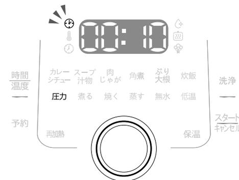
② 操作ノブを回して、圧力調理時間を設定し、操作ノブを押して確定します。
