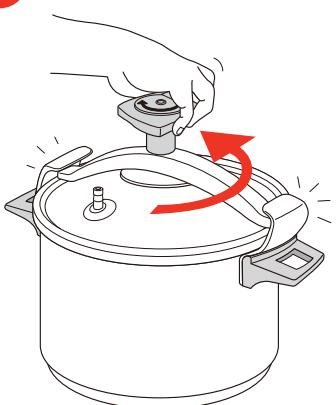
機能弁ノズルから蒸気が出なくなったことを確認し、しめハンドルを左(反時計回り)にゆっくりまわし、一旦とめたときに、ふたの隙間から蒸気が出ないことを確認してから、ふたを開けます。
