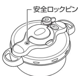
火を止めたあと、そのままにしておきます。安全ロックピンが完全に下がったら、セクターを回し、☼マークを圧力ぶたの目印位置にゆっくり合わせ、圧力ぶたを開けます。蒸らし時間の指定がある場合は、蒸らし時間が終了したら、セクターを回し、☼マークを圧力ぶたの目印位置に合わせるか、圧力ぶたに水をかけて、内部の蒸気を完全に抜いてから、圧力ぶたを開けてください。
