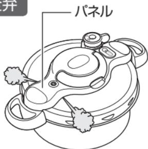
蒸気は安全弁を通り、圧力ぶたの白いパネル下から外に排出されます。
