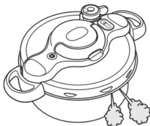
万一安全弁が作動しなかった場合は、パッキングの働きによって蒸気が圧力ぶたとなべの隙間から出るようになっています。
