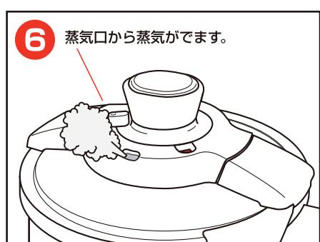
しばらくすると蒸気口から蒸気が出始めます。
