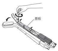
基板を裏返し、充電池に接続している コネクタ2箇所を取りはずします。
