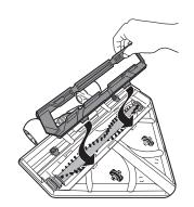
簡易工具を使って、ブラシカバーロックを 4 ロックの位置に動かします。
