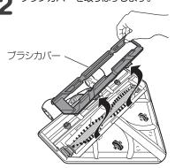
簡易工具を使って軸受部の突起を起こし、 電動ブラシを取りはずします。
