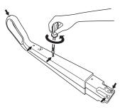
ハンドルカバーをはずし、基板のネジ 2箇所をはずします。
