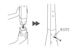
3 固定ネジを時計回りに回して締めます。 ハンドル部と本体をしっかり固定してください。
