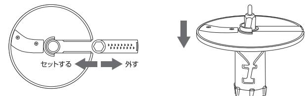
\*スライス／せん切りディスク使用時は、カッターをジョイント軸から外してください。
