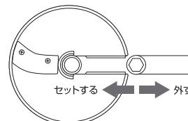
\*スライスをする場合でも、せん切りパーティは必ずセットしてください。せん切りパーティをセットしないと、ジョイント軸やスライス／せん切りディスクが破損する場合があります。
