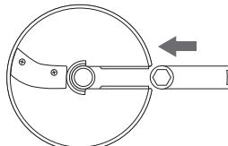
※スライスをする場合でも、せん切りパーツは必ずセットしてください。せん切りパーツをセットしないと、ジョイント軸やスライス／せん切りディスクが破損する場合があります。
