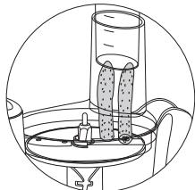
※スライス／せん切りディスク使用時は、カッターをジョイント軸から外してください。
