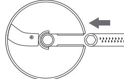
※スライス／せん切りディスク使用時は、カッターをジョイント軸から外してください。
