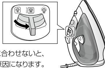
※ 給排水水中は「」に合わせないと、水漏れ・湯滴漏れする原因になります。
