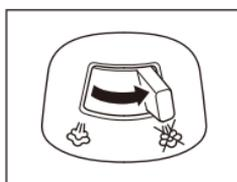
※ 給排水中は「**ス**」に合わせないと、水漏れ・湯滴漏れする原因になります。
