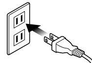
定格15A・交流100Vのコンセントを単独で使用してください。他の機器と併用すると、発熱による火災、故障の原因になります。
