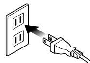
定格15A・交流100Vのコンセントを単独で使用してください。他の機器と併用すると、発熱による火災、故障の原因になります。
