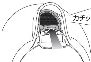
洗浄後、フィルターを乾かしてから注ぎ口にセットします。フィルターをセットするときは、注ぎ口カバーを開けながら、注ぎ口にフィルターをさしこみ、カチッと音がするまで静かに押し込みます。
