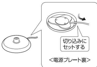
コードを電源プレート裏側に巻きつけて、長さを調節します。
