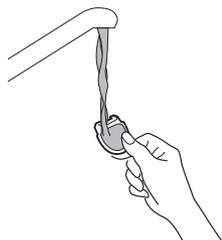
注ぎ口カバーを開け、フィルターのタブを持って引き抜き、水洗いします。
