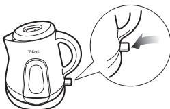
取っ手下部にある電源スイッチを押し下げて電源を入れます。
