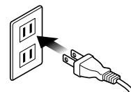
**注意** 定格15A・交流100Vのコンセントを単独で使用してください。他の機器と併用すると、発熱による火災、故障の原因になります。
