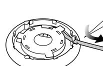
電源コードを電源プレート裏側に巻きつけて、長さを調節します。
