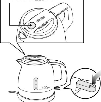
取っ手下の電源スイッチを押します。
