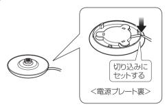
電源コードを電源プレート裏側に巻きつけて、長さを調節します。
