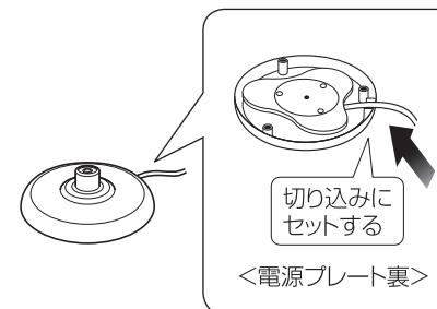
電源コードを電源プレート裏側に巻きつけて、長さを調節します。
