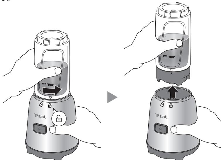
**!** 注意 ミキサーユニットは、モーターが完全に止まり、電源プラグをコンセントから抜いた後で取りはずしてください。
