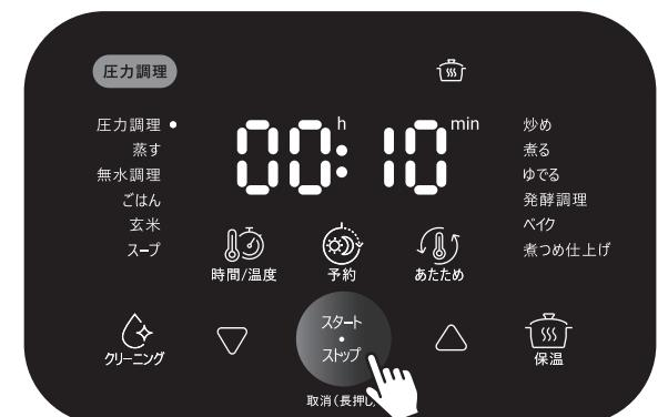
予熱が完了すると「ピーピーピー」と3回音が鳴って、圧力調理が始まり、タイマーのカウントダウンが始まります。
