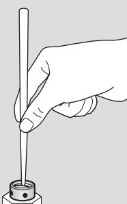
先の丸いはしななどで強めに押し、バネが押し戻すような感触があるか確認します。
