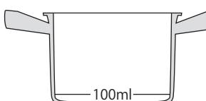
圧力調理するときは、水やスープ、だし汁などの水分を最低100ml入れてください（ローストビーフ等の一部料理につきまして、100ml以下の水分量でも問題ない料理がございます）。目安として10分の圧力調理で約100mlの水分が蒸発します。
