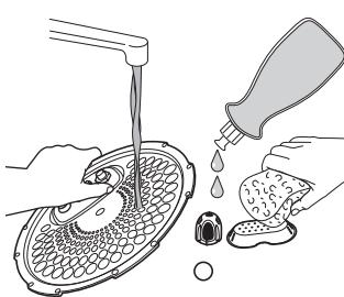
金属ふたからバルブカバー、ボールカバー、減圧ボールを取りはずし、各部品を中性洗剤で洗います。(取りはずし方は16ページ「圧力調理前の点検事項」を参照してください)
