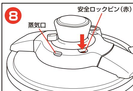
蒸気口より全く蒸気が出なくなり、安全ロックピン(赤)が完全に下がった事を確認したら、セレクターをハートマークへ回して中の蒸気を排出し、オープンボタンを押してふたを開けてください。
