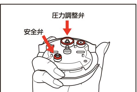
圧力調整弁を押して、スムーズに上下に動くか確認してください。安全弁は、はし等でまん中のへこみの中の突起部を押して上下に動くか確認してください。また、食べ物のカスなどで汚れていないかどうか、確認してください。
