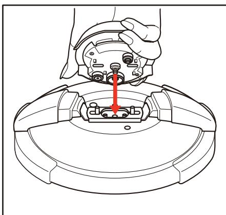
ふたの取りつけ部分にコントロールパネルの形が合うようにセットします。
