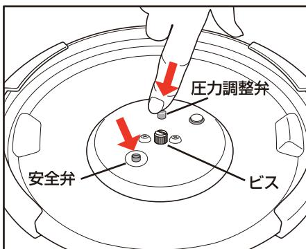
コントロールパネルを取りつけると、ふたの内側の赤い矢印の部分に、圧力調整弁と安全弁の先端が出てきます。
