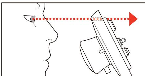
明るい方向へかざして蒸気口が目詰まりしていないか確認します。
